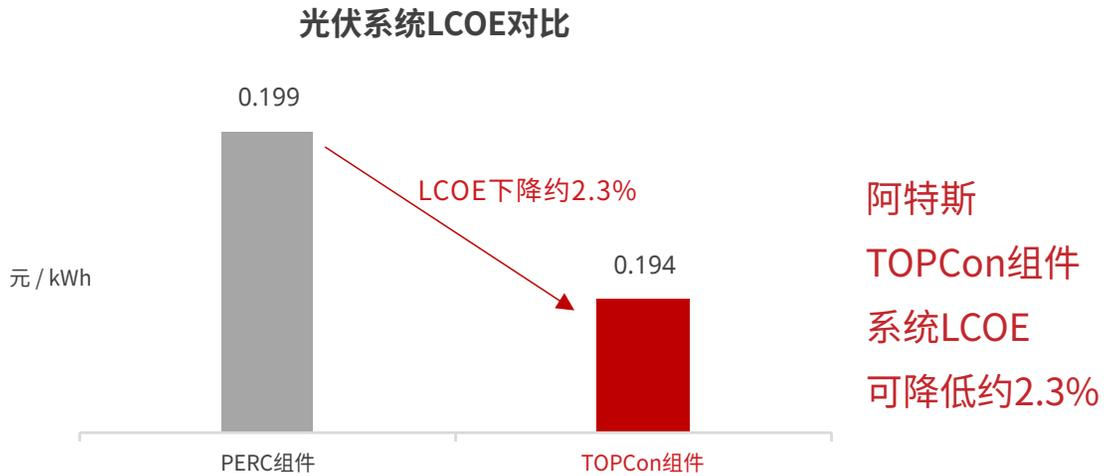
图12. 使用TOPCon与PERC双面组件的光伏系统LCOE对比
