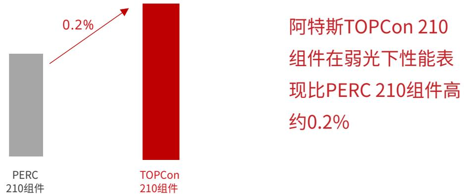
图4. TOPCon与PERC组件弱光性能对比
